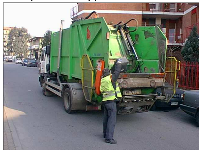
Obr. 3: Ruční sběr kuchyňského odpadu - kuchyňský odpad není stlačován
